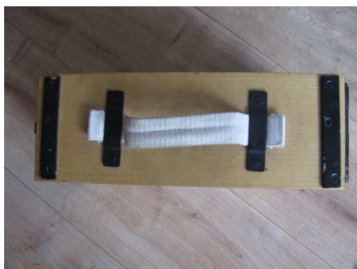
Obr. 10 – Kování víka ZB 26 – třmeny, popruh, pásky.
